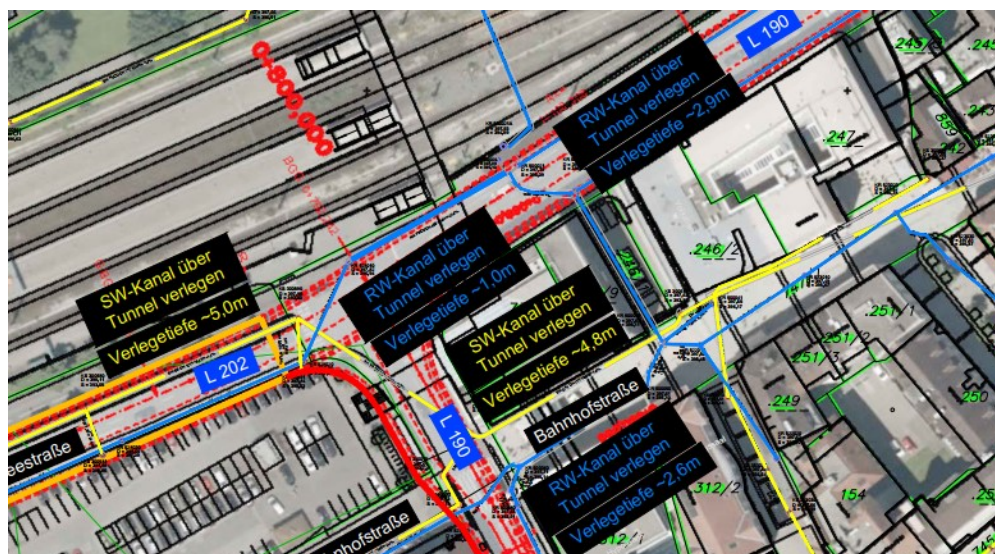
Abbildung 24: Vorhandene Einbauten im Bereich der Kreuzung L202 / L190
