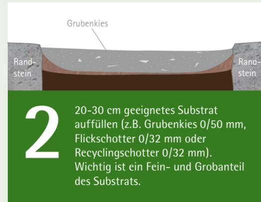
**2** 20-30 cm geeignetes Substrat auffüllen (z.B. Grubenkies 0/50 mm, Flickschotter 0/32 mm oder Recyclingschotter 0/32 mm). Wichtig ist ein Fein- und Grobanteil des Substrats.
