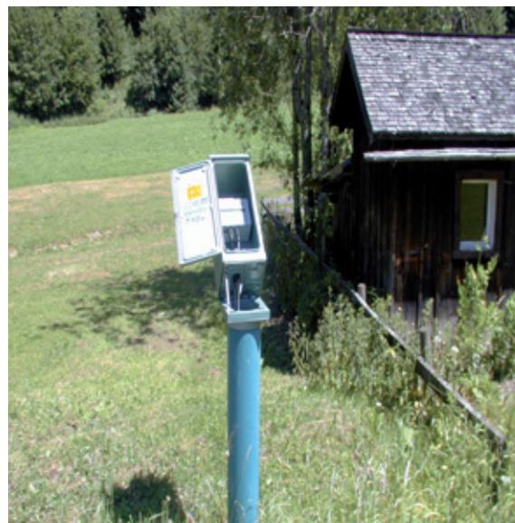
Abb 25: Grundwasser-Messstelle
