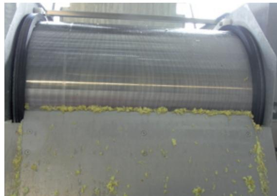
Abb 37: Vorreinigungsanlage in der Lebensmittelindustrie
